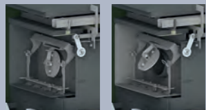
Rauchgasklappe geschlossen Rauchgasklappe geöffnet
