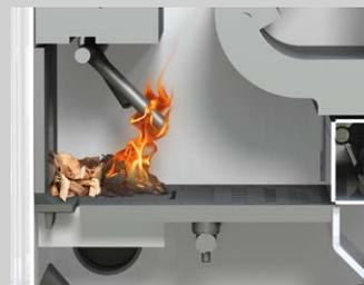
La zone de braises résiduelles évite un nouvel allumage après la fermeture de la grille basculante et permet une reprise rapide de la combustion.
