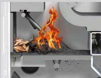
Lorsqu'elle est fermée, la grille basculante garantit un lit de braise et une combustion optimale.
