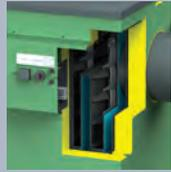
Das serienmäßige, automatische **Abreinigungssystem** der stehenden Wärmetauscherflächen sorgt für einen effizienten Wärmeübergang. Über einen kraftvollen Exzenterantrieb werden die integrierten, patentierten Abreinigungsturbulatoren periodisch bewegt und die Wärmetauscherflächen weitgehend von Flugasche befreit. Die neuen, verbesserten, in sich beweglichen Turbulatoren erhöhen diesen bereits sehr guten Reinigungseffekt nochmals. Reinigungsarbeiten werden so auf ein Minimum reduziert.
