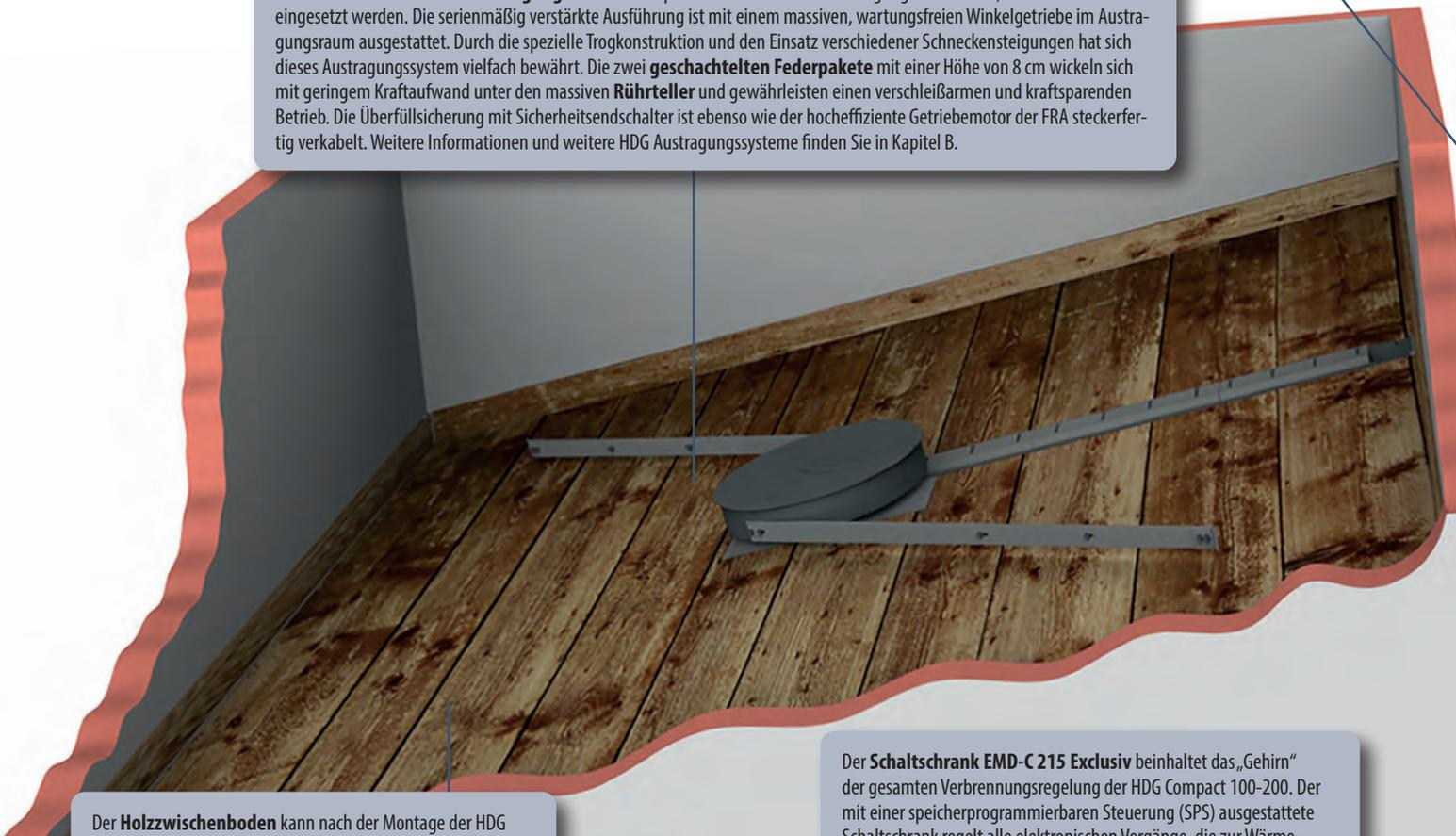
Der **Holzzwischenboden** kann nach der Montage der HDG Federkern-Raumaustragung bauseitig im Austragungsraum angebracht werden. Das stellt eine „glatte“ Austragungsfläche sicher. So kann das Austragungssystem optimal und mit geringem Kraftaufwand arbeiten. Durch ein neuartiges Dosier- und Einlaufblech am Schneckenkanal kann auf den Zwischenboden auch verzichtet werden.
