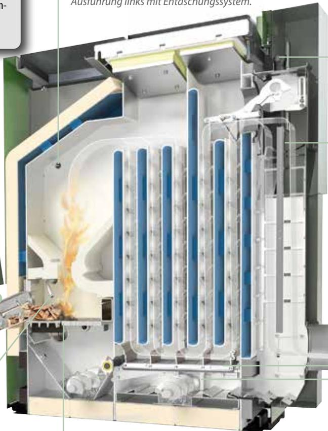
Bei der HDG Compact 30-149E garantiert die **elektrostatische Abscheidertechnik** dauerhaft niedrige Feinstaubwerte über den gesamten Betriebszyklus – vom Anheizen bis zum Ausbrand. Alle anfallenden Feinstaubpartikel werden vollautomatisch abgereinigt, gesammelt und genau wie die anderen Verbrennungsrückstände in den zentralen Aschenbehälter gefördert.
