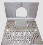
Durch den massiven, luftgekühlten und zudem direkt beschickten **automatischen Kipprost** aus Grauguss und die bewährte heiße Brennkammer wird eine gleichmäßige Leistung sichergestellt. Die Brennkammerelemente sind einzeln zu entnehmen und werksseitig gebrannt. Die Verbrennungsrückstände werden durch den Rost zuverlässig in den unteren Aschenbereich gekippt.
