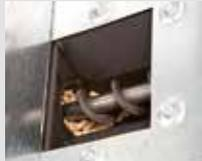
Die Pellets werden bedarfsabhängig über eine getaktete **Dosierschnecke** und über einen nachfolgenden Schräg-abwurf dem Brennerkopf zugeführt. Die angebaute Temperaturüberwachung mit integriertem Wasserbehälter sorgt dabei für ein Höchstmaß an Betriebssicherheit.
