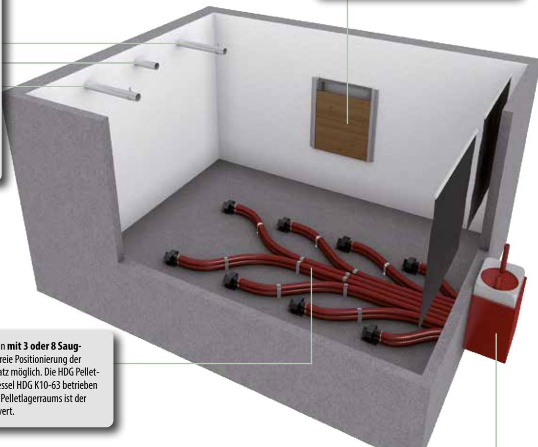
Die **HDG Pellet-Schlauchweiche** kann mit **3 oder 8 Saugsonden** betrieben werden. Durch die freie Positionierung der Sonden ist ein besonders flexibler Einsatz möglich. Die HDG Pellet-Schlauchweiche kann mit dem Pelletkessel HDG K10-63 betrieben werden. Zur optimalen Entleerung des Pelletlagerraums ist der Einbau von Holzschrägen empfehlenswert.
