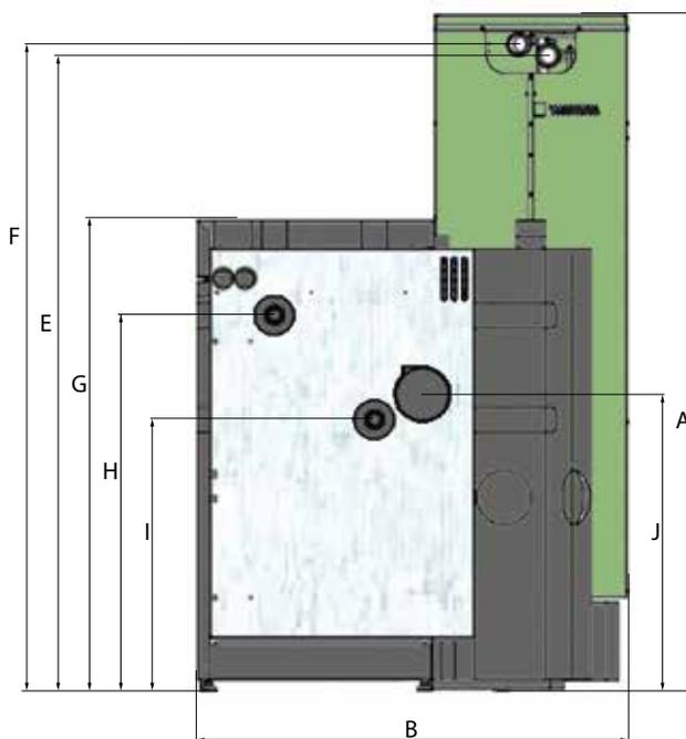
Hinweis: Die hydraulischen Anschlüsse können innerhalb der Verkleidung auch nach von hinten gesehen oben, rechts (durch größeres Saugzuggebläse nicht bei HDG K33) und links verlegt werden.
