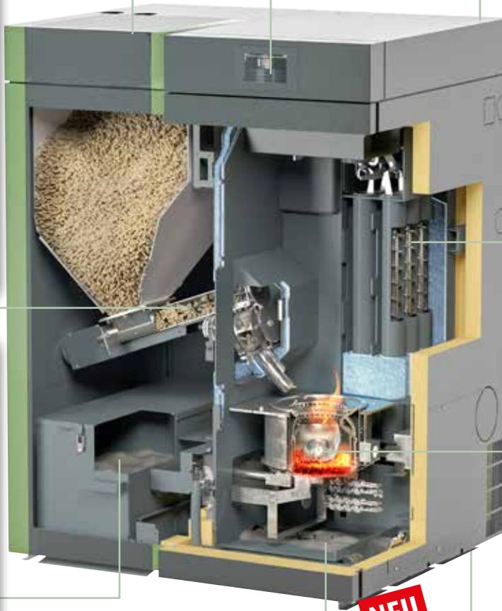
Der **Edelstahl-Brennertopf** mit vollautomatischer Brennertopfentäschung sorgt für eine hohe Betriebssicherheit bei niedrigem Pelletverbrauch. Die automatische Zündung über keramische Heizelemente ermöglicht einen schnellen, effizienten Betriebsstart. Die integrierte Sekundärluftführung mit optimaler Luftvorwärmung sorgt für niedrigste Emissionswerte.
