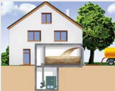
Beispiel: Pelletlagerraum mit Einblasvorrichtung
