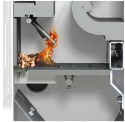
Durch die Restglutzone ist ein neues Zünden nach dem Schließen des Kipprosts bei kurzen Stillstandszeiten häufig nicht erforderlich.
