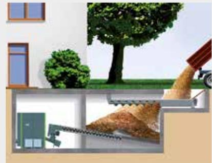
Beispiel: Lagerraum im Keller mit Einbringerschnecke zur Befüllung über den Lichtschart
