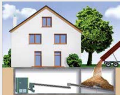
Beispiel: Transport des Brennstoffs von weit entferntem Lagerraum über zweite Förderschnecke
