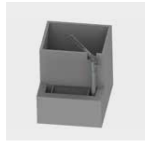
Befülltrog versenkt mit Steig- und Befüllschnecke
