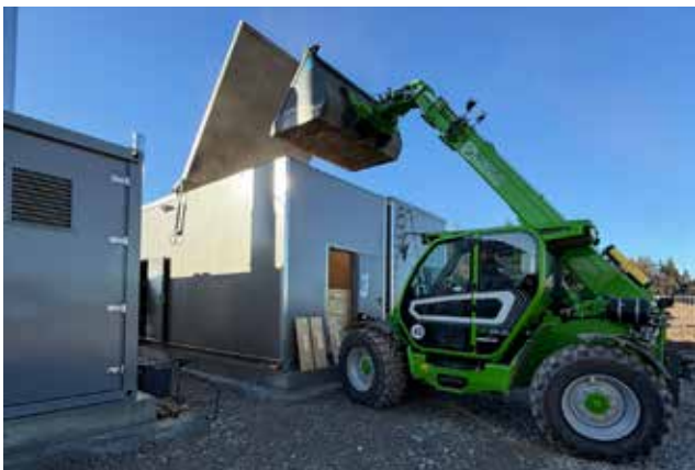
Befüllung mit Teleskop- oder Frontlader
