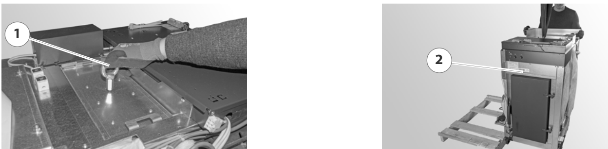
Abbildung 4/7 - Transportpalette entfernen per Kran
