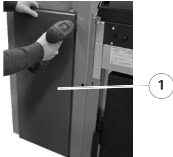
Abbildung 4/32 - Frontverkleidung unten montieren
