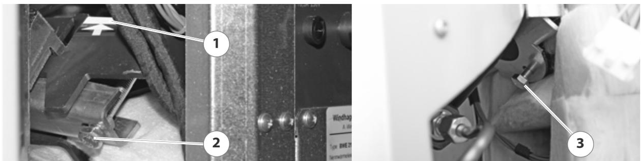
Abbildung 4/17 - Vorratsbehälter festschrauben
