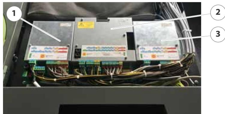
Abbildung 4/40 - Erweiterungsmodule montieren
