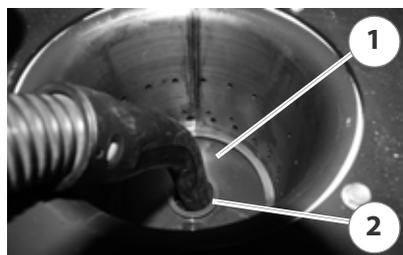
Abbildung 7/15 - Primärluftrohr reinigen
