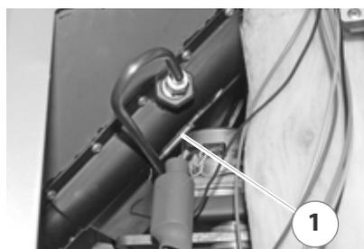
Abbildung 4/18 - Fühler Sicherheitsthermostat einbauen
