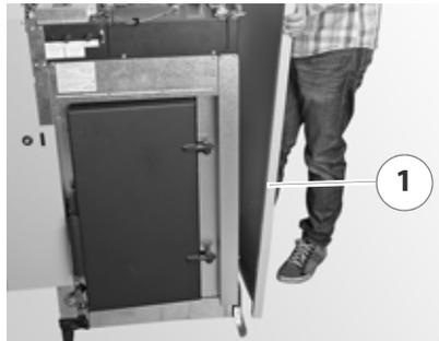
Abbildung 4/31 - Seitenwand einhängen
