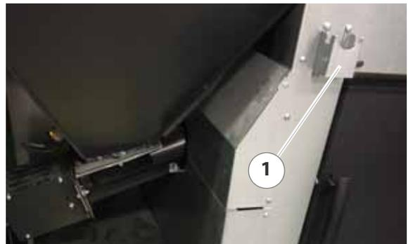
Abbildung 4/48 - Verschlussblech montieren
