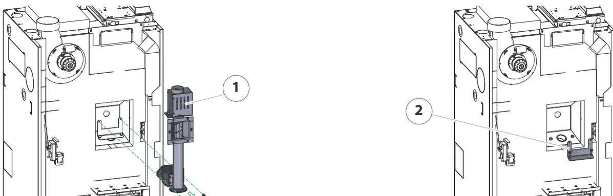
Abbildung 4/18 - Einheit Zellenrad schleuse-Schneckenrohr demontieren
