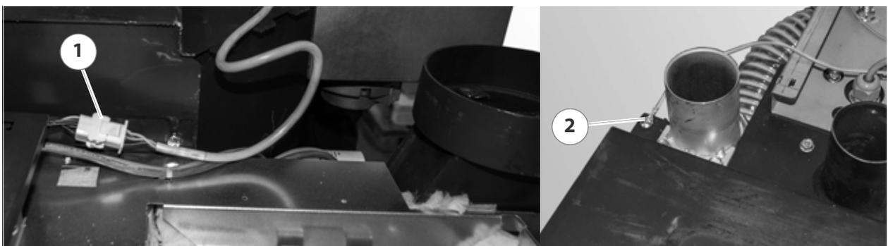
Abbildung 4/26 - Netzstecker montieren
