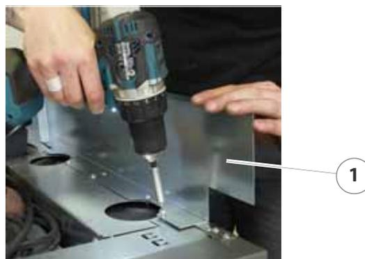
Abbildung 4/40 - Rechtes hinteres Verkleidungsoberteil montieren
