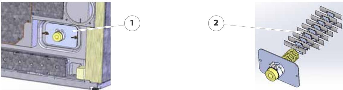
Abbildung 4/13 - Elektrode montieren
