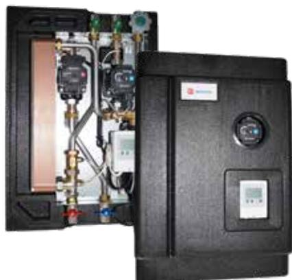
Die Frischwarmwasserstation wird für die bedarfsgesteuerte Trinkwassererwärmung im Durchflussprinzip in Verbindung mit einem Pufferspeicher bei bestehenden und neuen Heizungsanlagen eingesetzt. Die Station ersetzt die Bevorratung von Trinkwarmwasser in einem zusätzlichen Speicher und bietet somit einen hohen Schutz vor Legionellen, durch die Vermeidung von Stagnationswasser.
